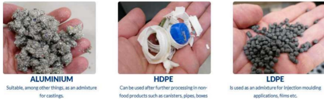
[그림 17] 폴리알에서 폴리에틸렌 수지를 분리해 플라스틱 성형 원료로 재생산한 사례(Palurec社)
