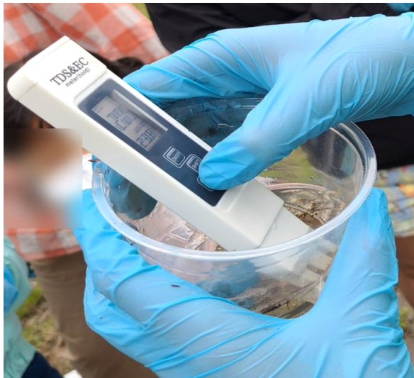
그림 7 수질 검사기를 이용한 TDS/EC 측정
